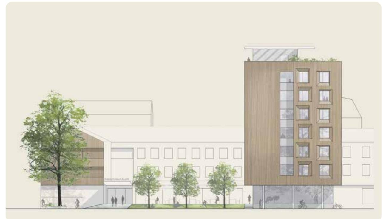
Ab Juni 2022 ein einzigartiger 7-geschoßiger Holzbau mit kleinen Wohneinheiten errichtet werden. Dabei wird ein 6-geschoßiger Holzkörper auf einem Sockel aus Sichtbeton entstehen. Das obige Bild zeigt den ersten Entwurf aus dem Wettbewerbsplakat für den Neubau des Internatsgebäudes.
