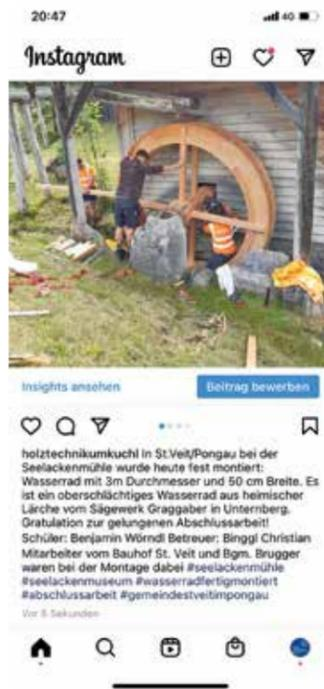
Zuerst wurde die Probefräsung aus Tanne angefertigt um zu sehen ob die CAD Zeichnung übereinstimmt. Mit der Freigabe der Probefräsung konnten anschließend die Lärchenteile angefertigt und mit dem Zusammenbau begonnen werden. Die Innenringe bzw. Hauptringe wurden sehr schnell verleimt und mit Holzgewindeschrauben verschraubt.
