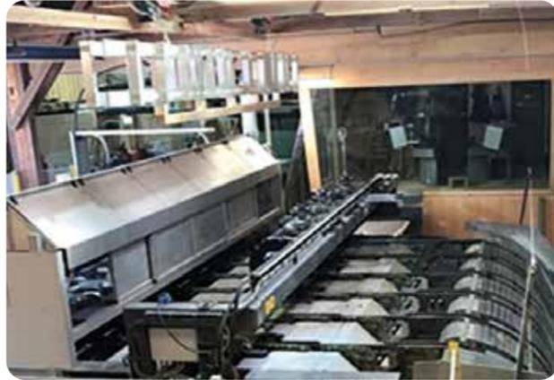
Ziel dieser Diplomarbeit war es, die Schnittholzmesseinrichtung im Sägewerk zu überprüfen. Ein Teil dieser Diplomarbeit bestand darin, anhand einer Analyse aus Vergleichsmessungen zwischen manueller und auto-
